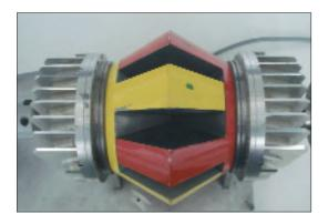
Bild 7. Blick in das Innere einer Schukey-Maschine. Zu sehen sind die beiden Flügelkreuze (rot und gelb). An den Spitzen links und rechts befinden sich die beiden Getriebe. Jedes Getriebe treibt jeweils einen Rotor an Quelle: Bergholter
